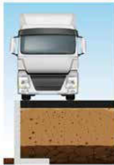
LF5a GAMMA ELF Schwerer Verkehr nach DIN EN 1991-2 Randabstand 0 m SLW 60
